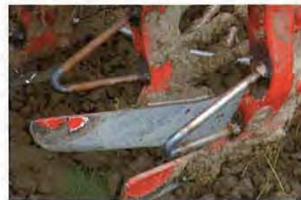
(Foto 2) Beugels boven de rooischaren voorkomen dat bieten over de scharen springen en verloren gaan.
